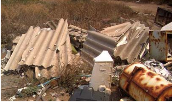
Asbestgolfplaten als dakbedekking
